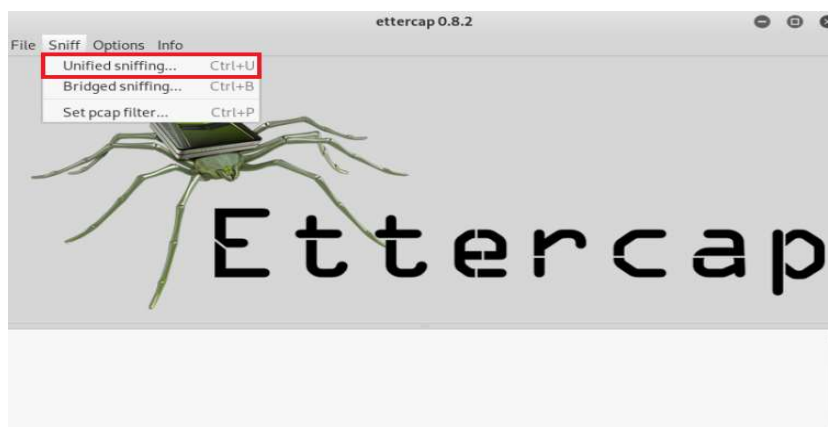
ภาพที่ 2.12 การกำหนดโหมดของการดักจับข้อมูล
