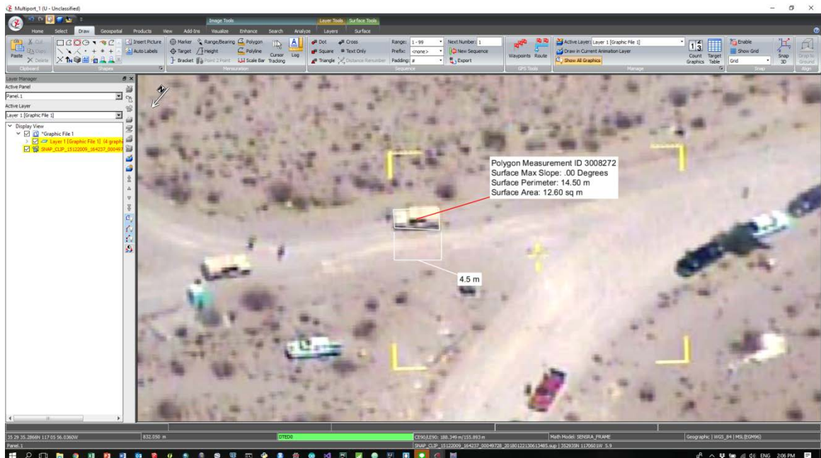
ภาพที่ 2.7 ตัวอย่างภาพถ่ายที่ใช้งานในโปรแกรม SocetGxp แบบแสดงพิกัดสามารถทำการวัดระยะ
