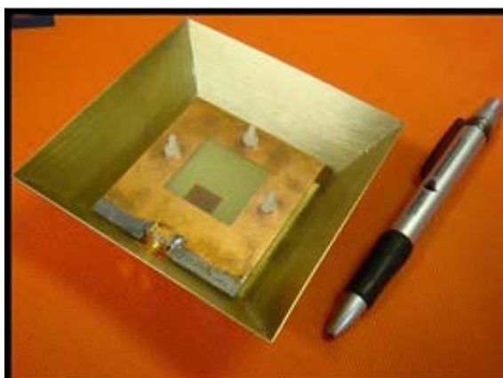
ภาพที่ 1-15 สายอากาศแบบแผ่นขนาดเล็กโดยใช้โครงสร้างแบบคลื่นแม่เหล็กแถบแคบกันหอย
