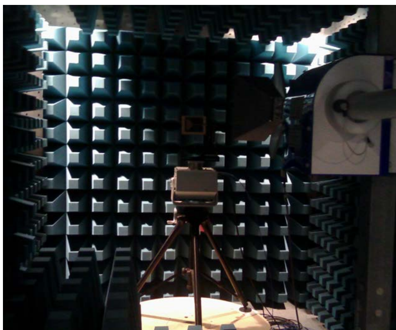
ภาพที่ 3-8 การทดสอบอัตราขยายของสายอากาศในห้อง Chamber
