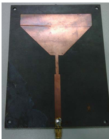
ภาพที่ 2-23 ชิ้นงานจริงของสายอากาศโมนิโพลแบบที่ 3
