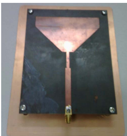
ภาพที่ 2-24 ชิ้นงานจริงของสายอากาศโมนิโพลแบบที่ 4
