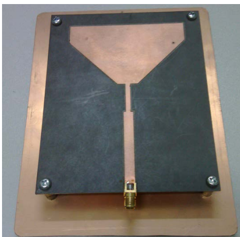
ภาพที่ 2-22 ชิ้นงานจริงของสายอากาศโมนิโพลแบบที่ 2
