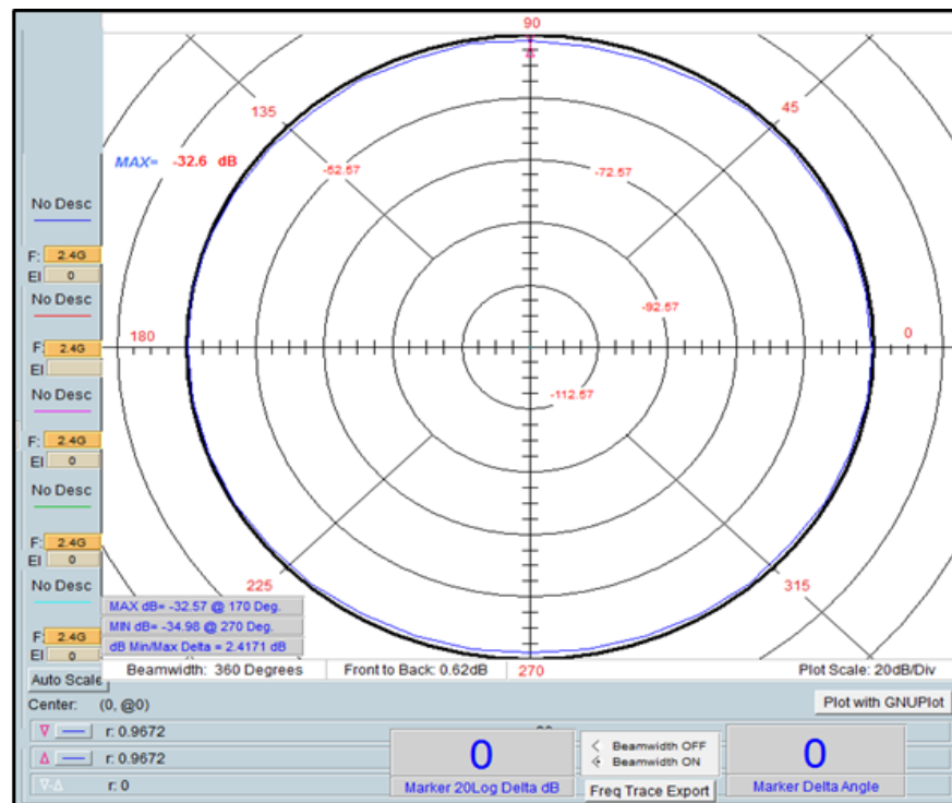
ภาพที่ 3-18 อัตราขยายและรูปแบบการแผ่กระจายคลื่นของสายอากาศแบบที่ 3 แนวแกนนอน ความถี่ 2400 MHz
