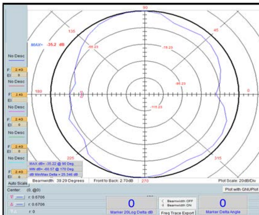
ภาพที่ 3-19 อัตราขยายและรูปแบบการแผ่กระจายคลื่นของสายอากาศแบบที่ 3 แนวแกนตั้ง ความถี่ 1800 MHz
