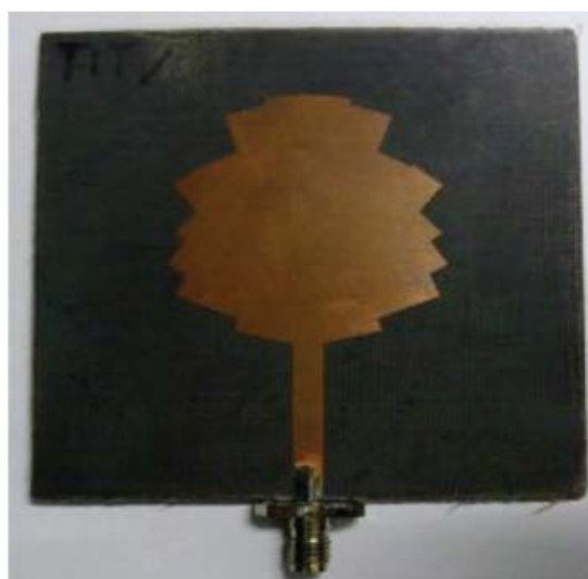
ภาพที่ 1-9 โครงสร้างสายอากาศอาเรย์ LTE และ MIMO
